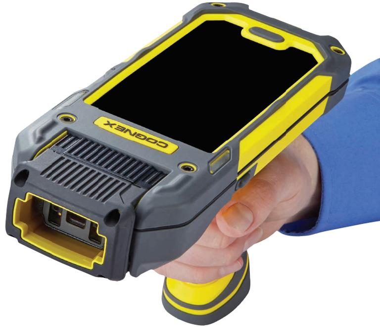
MX-1502 UV 비전 지원 모바일 단말기는 산업용 바코드 판독 및 애플리케이션을 위해 최신 모바일 기기 기술을 활용할 수 있도록 해 드립니다. UV 조명 모듈과 렌즈 필터를 이용하는 MX-1502 UV는 Cognex의 고성능 디코딩 알고리즘을 이용해서 육안 인지가 불가능한 코드에 조명을 적용하고 신속하게 디코딩합니다.
